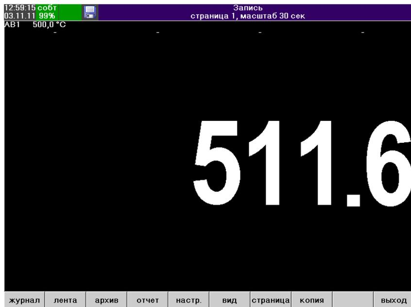
вычислить коэфф.  $k = T_{\text{заданн.}} / T_{\text{изм.}}$ . Ввести полученный коэффициент в пользовательское выражение и загрузить конфигурацию в прибор.
