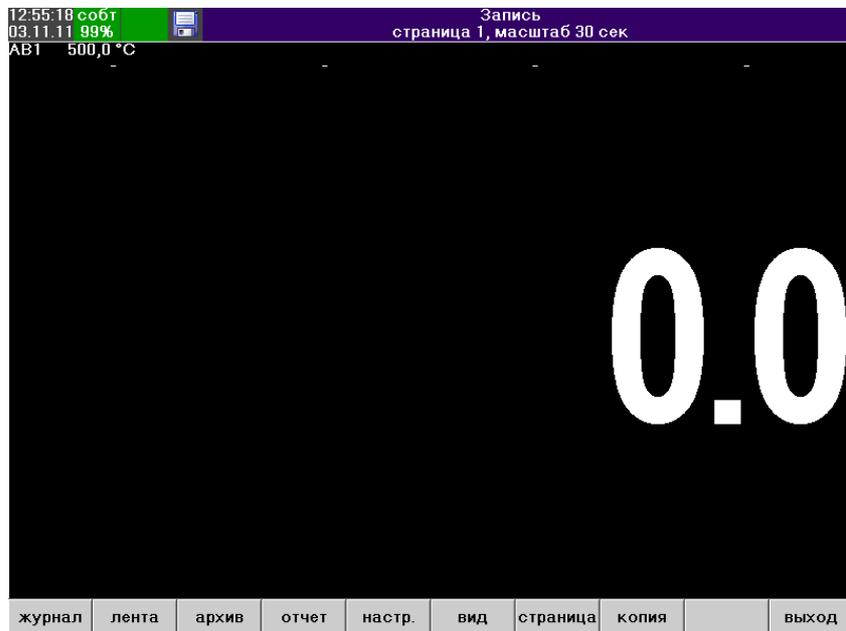
5. Задать на магазине сопротивлений (калибраторе) сопротивление, соответствующее верхнему пределу измеряемого диапазона (в примере – 500 °С). Используя показания прибора,
