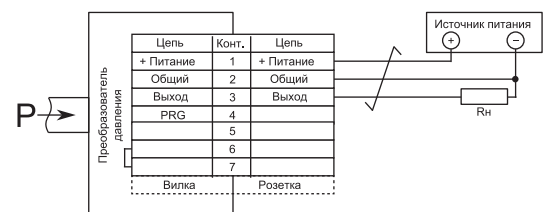
Схема подключения преобразователей с разъемом 2РМДТ 18Б7Ш1В1В, контакты 6 и 7 вилки соединены перемычкой
