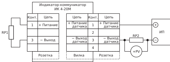
Схема подключения ИК 4-20М к контрольно-измерительному оборудованию при калибровке.
