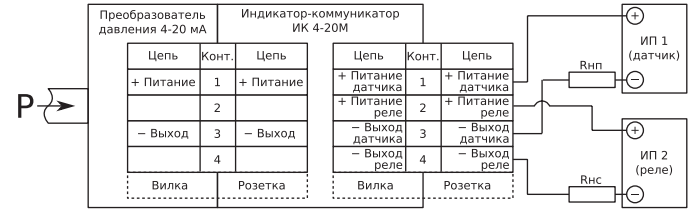
Схема подключения ИК 4-20М к преобразователю с выходным сигналом 4-20 мА («ИП 2» необходим только для работы функции сигнализатора в исполнениях «01» и «02»).
